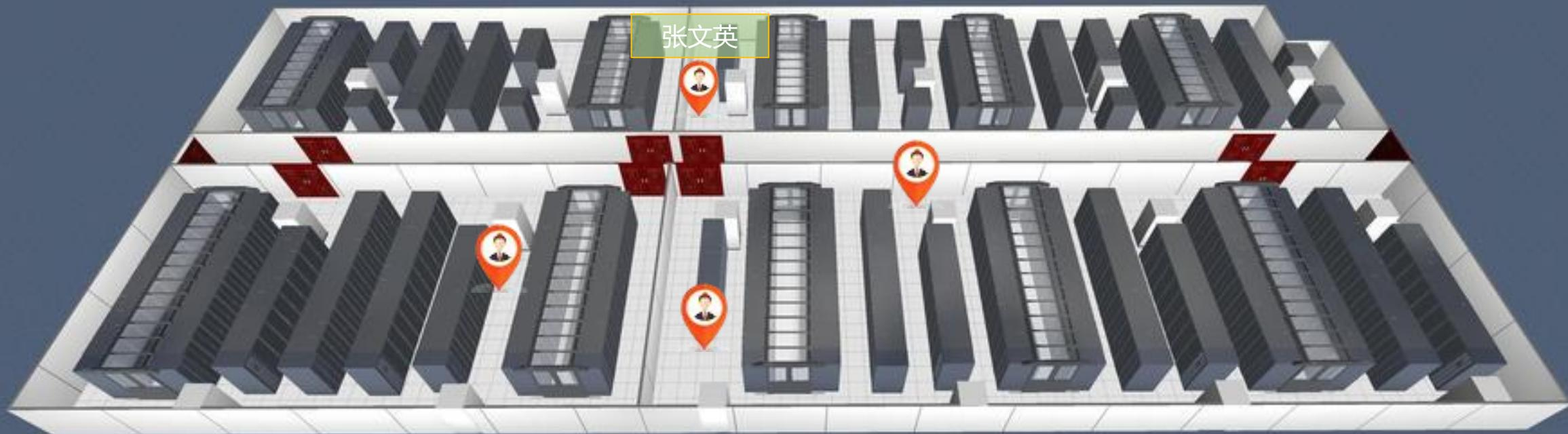
全局位置显示：软件上实时显示人员的实时位置，显示在地图中,实时获取巡检人员位置轨迹信息，掌握机房内人员动态。
